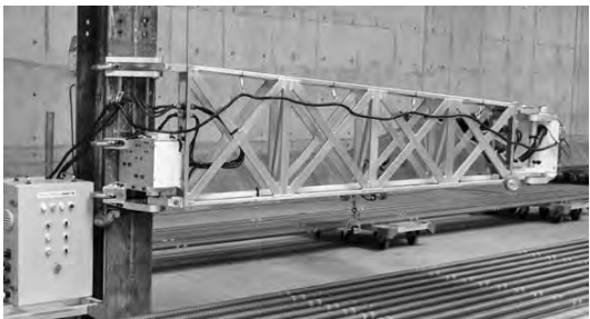
写真—4 変更後第一アーム構造写真
