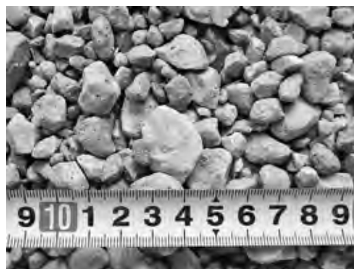
写真四 再生粗骨材 CH
