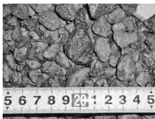
写真三 再生粗骨材 BH
