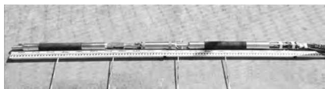
写真一 2 先端注入装置外観（実用機）
