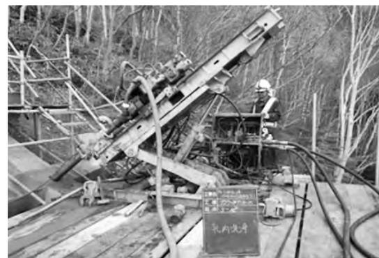
写真一3 ロータリーパーカッション削孔機
