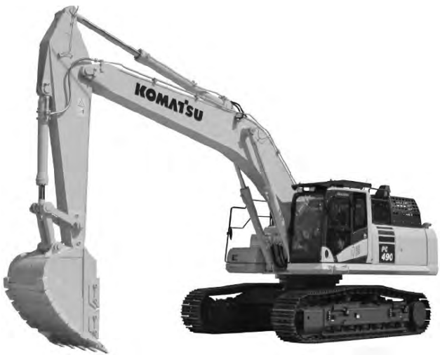
写真―3 コマツ PC490-11N0 油圧ショベル (一部オプションが含まれる)
