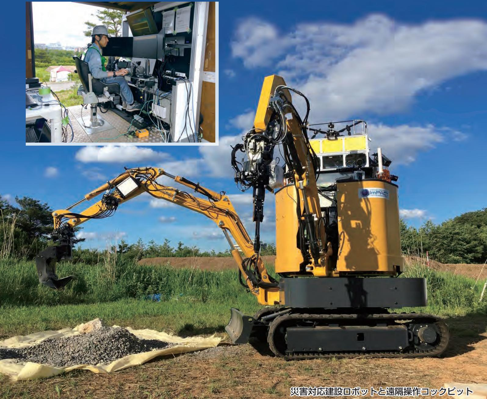
災害対応建設ロボットと遠隔操作コックピット
