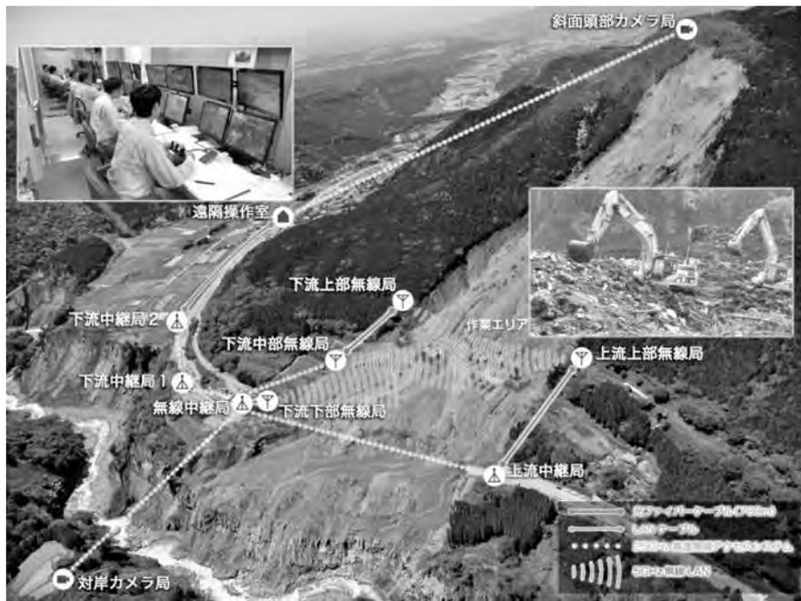
図一3 阿蘇大橋地区斜面防災対策工事無線システム概要図
