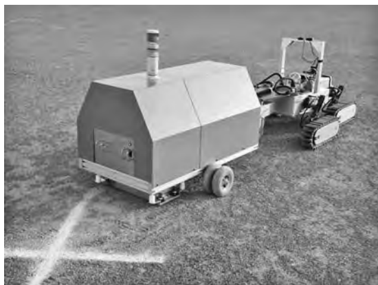
写真一3 RI試験自動化実証実験の様子
