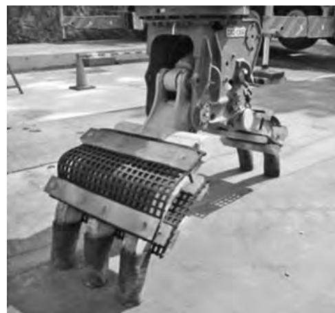
写真—12 緩衝材取付状況
