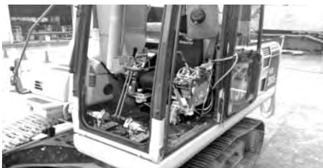
写真—1 汎用遠隔操縦装置『本装置』の装着状況
