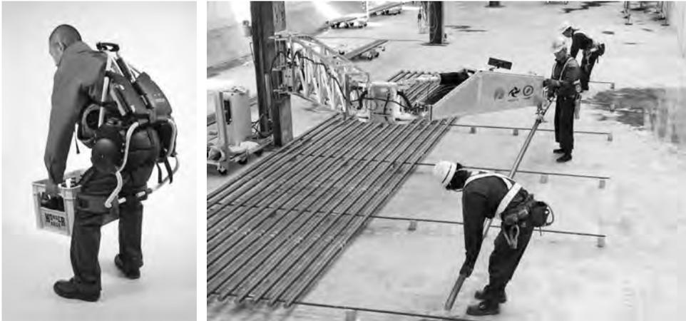
写真-1 パワーアシストスーツ (左) とパワーアシストアーム (右)
