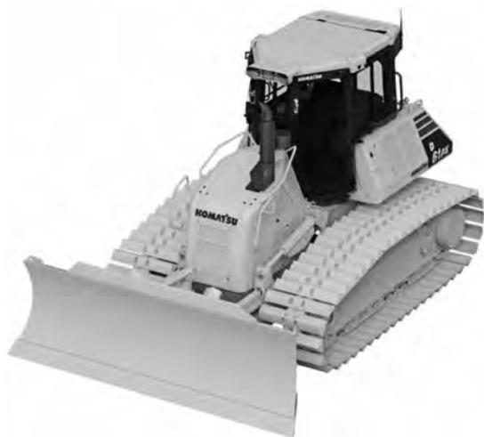
写真—11 コマツ D61PXi-24 ICT ブルドーザー
