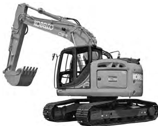
写真-4 コベルコ建機 SK225SR-5 油圧ショベル (後方超小旋回型)
