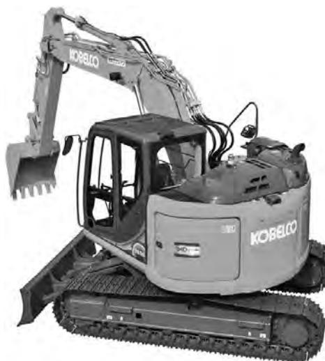
写真-2 コベルコ建機 SK135SR-5 油圧ショベル（後方超小旋回型）
