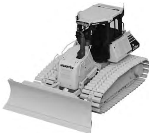
写真-1 コマツ D61PX-24 ブルドーザー
