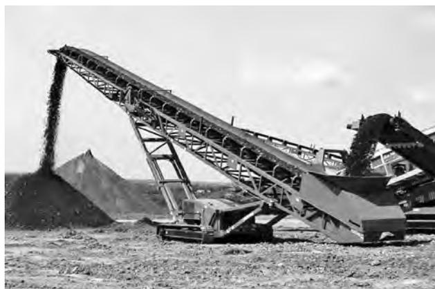
写真-6 ST80T 自走式ベルトコンベヤ
