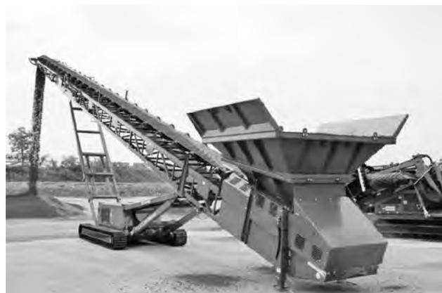
写真-7 ST80TV 自走式ベルトコンベヤ
