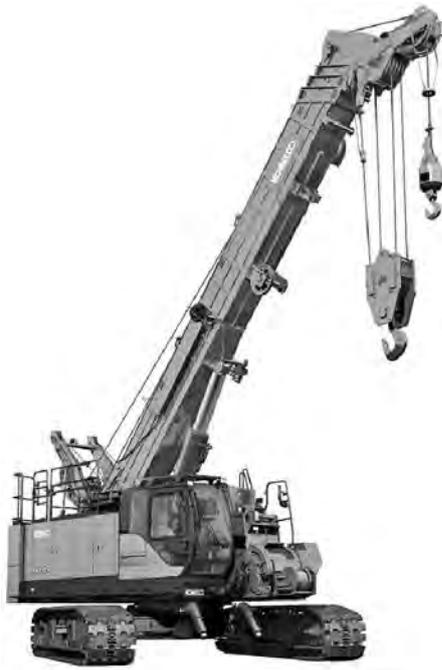
写真—8 コベルコ建機 TK750G/TK750GFS テレスコピッククローラークレーン
