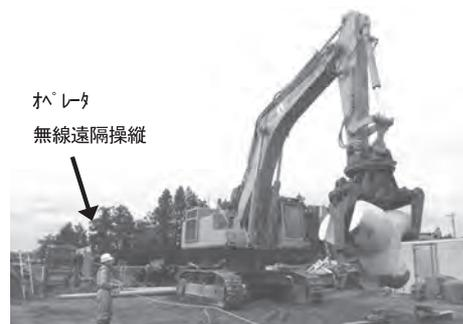
写真一 5 HETORONIC 社 無線遠隔操縦装置
