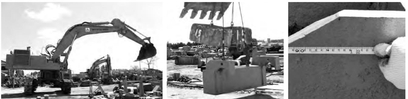
写真一 水陸両用バックホウ転倒実証試験状況
