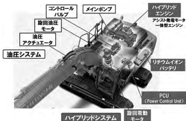
図-5 ハイブリッド油圧ショベルの機器配置
