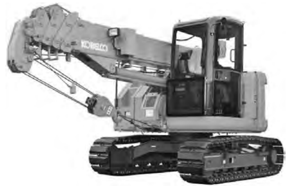
写真一 2 小型伸縮ブームクローラクレーン
