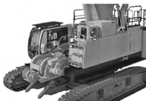
写真-6 サードウインチ配置
