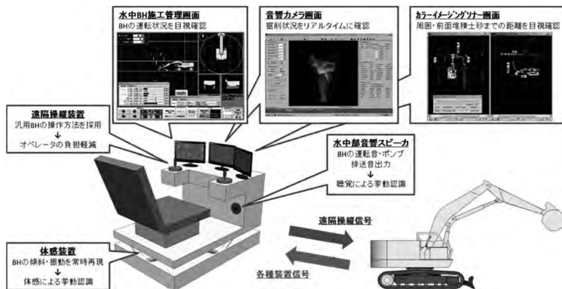
図—1 水中バックホウ施工支援システム概要
