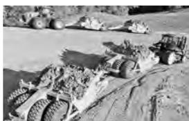
写真-40 農耕トラクタ牽引
