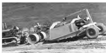
写真一九 “Carryall” Model-A と “Tournapull” Model-A
