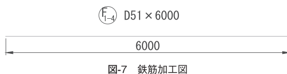
図-7 鉄筋加工図
