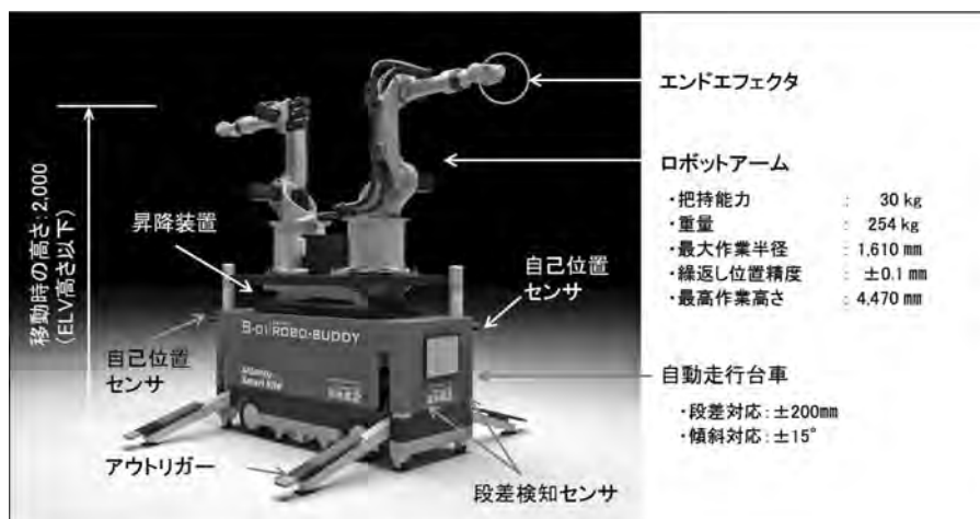
図一4 多能工作業ロボットの概要
