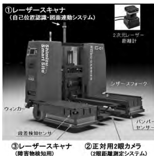
図―5 自動搬送ロボットの概要
