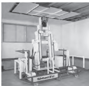
'89 天井ボード貼りロボット
