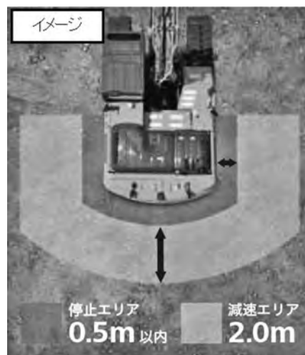
図—8 自動減速／停止エリア(概略の検知エリア)
