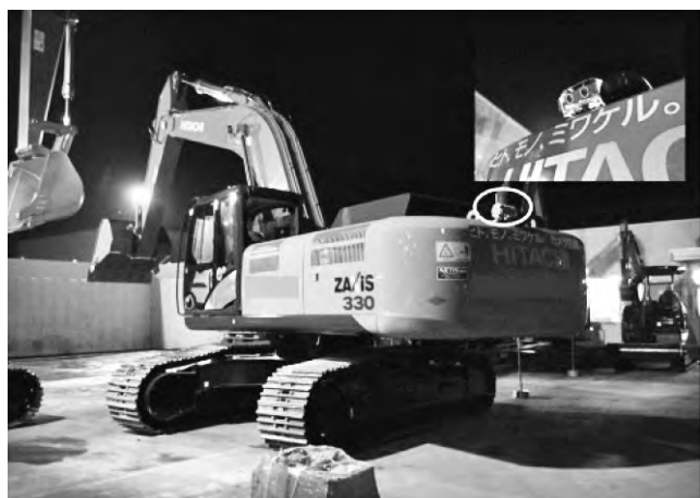
写真—2 夜間工事向けに高感度センサを採用した例
