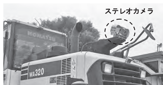
写真一 4 ステレオカメラ搭載状況
