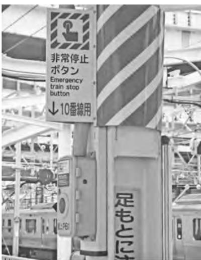
写真一五 列車防護訓練 (列車非常停止警報装置)
