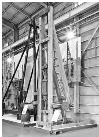
写真—3 レオナルド・ダ・ヴィンチの土質調査機
