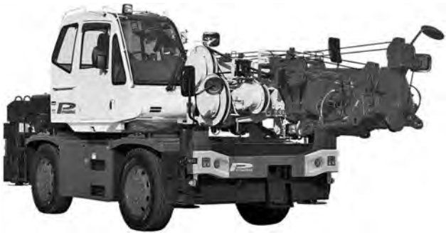
写真一 5 タダノ GR-130F ラフテレーンクレーン（回送姿勢）
