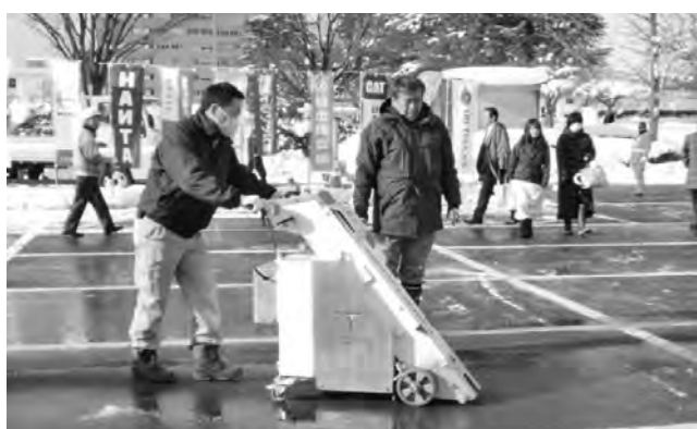
写真—28 西尾レントオール 路面解氷機トルネード
