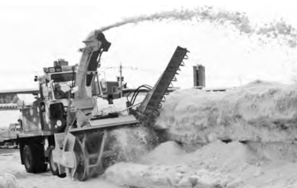
写真一8 ダイナミックなロータリ除雪機のデモンストレーション
