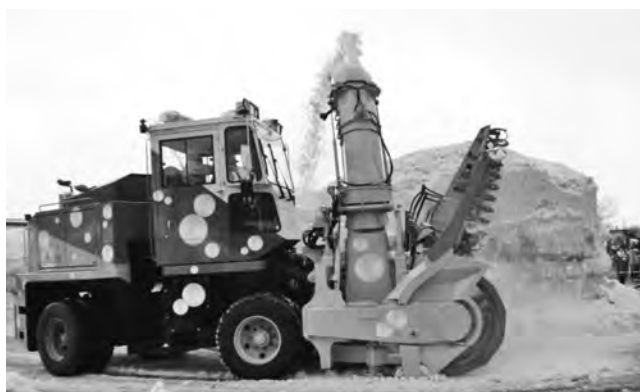
写真—27 新潟トランス ロータリ除雪機 NR303
