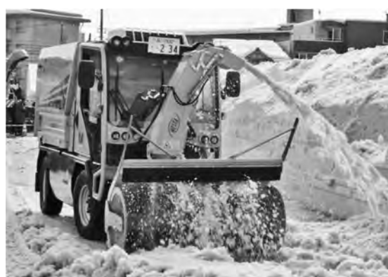
写真—31 矢野口自工 LADOG ロータリ除雪アタッチメント
