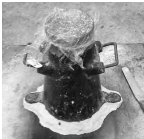
写真—4 静置スランプ試験 試験状況
