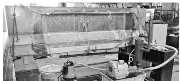
写真一2 模擬I型桁に対する施工実験状況
