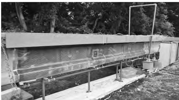
写真一1 I型PC桁に対する施工実験状況
