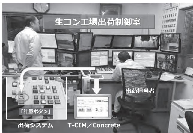
写真-1 出荷担当者による運用状況 (出荷システムの計量と本システムの出荷)
