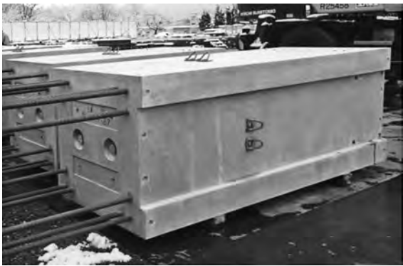
写真—4 柱部材の突起形状
