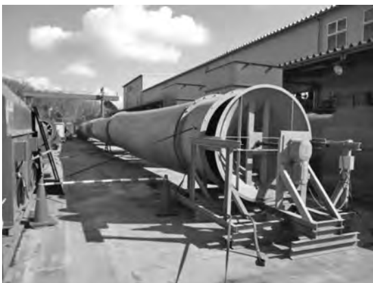
写真-14 3,000 m 3 /分 (160 kW × 4 連) ファン性能試験
