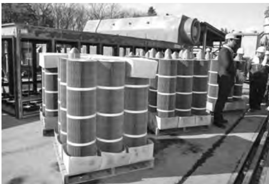
写真-13 集塵機フィルター（新品）
