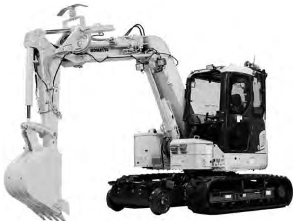
写真-1 コマツ PC78UUT-10 軌道陸上兼用油圧ショベル (一部オプションが含まれる)
