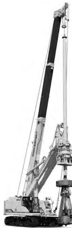
写真一 5 日立住友重機械建機クレーン SDX407-2 アースドリル
