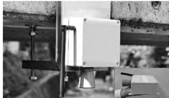
写真一七 洪水に特化した低コストの水位計の事例
