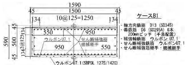
図-4 補強配筋断面図 (ケース B1)
