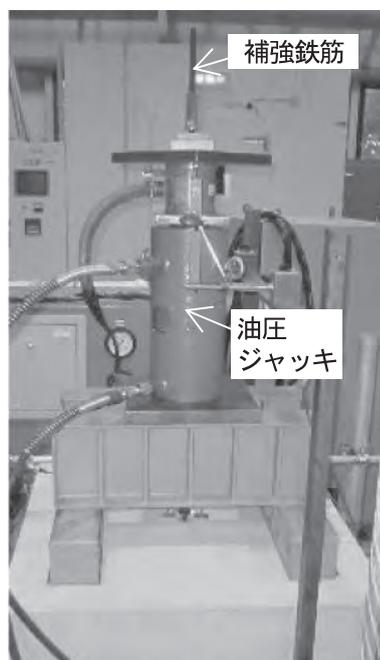
写真-1 引き抜き試験状況
