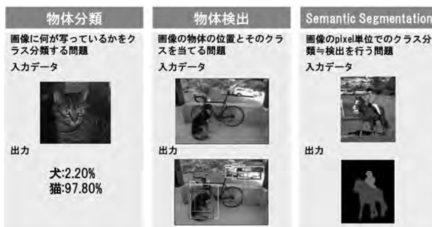
図—4 ディープラーニングによる主な画像認識手法
