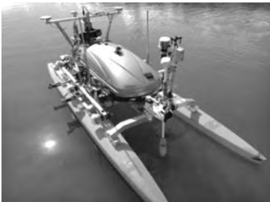
写真 1 水中点検ロボット
