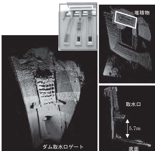
図-10 ROVによるダム取水口計測結果
