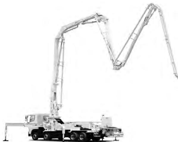
写真 1 極東開発工業 PY165-39 コンクリートポンプ車
