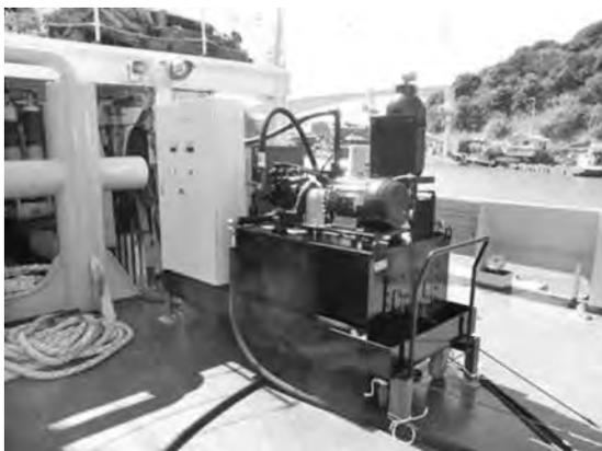
写真—5 油圧ユニット機装状況
