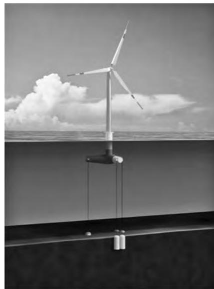
図一 12 TLP 型浮体式洋上風車
