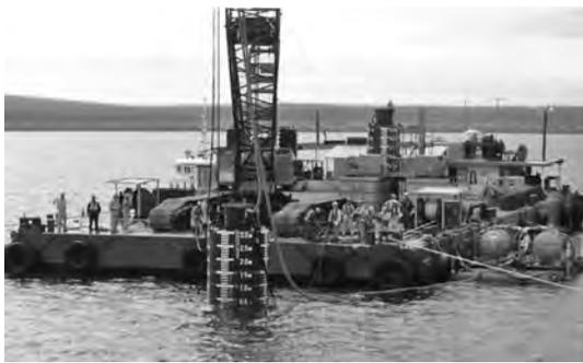
写真一六 引抜実験試験体設置状況
