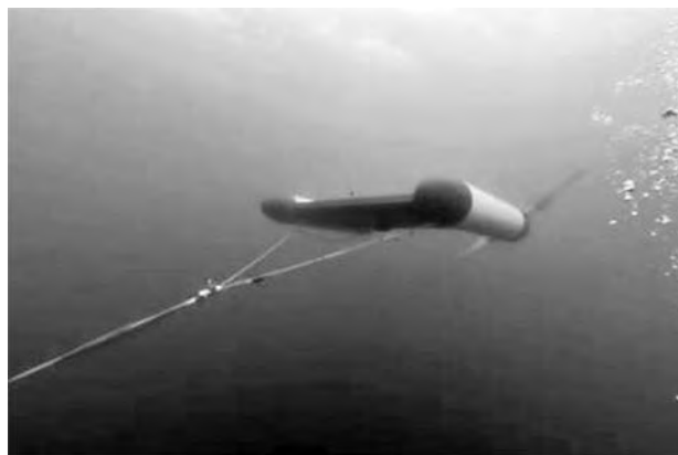
写真—1 1/25スケール実験機による水中浮遊式浮体の海中試験
