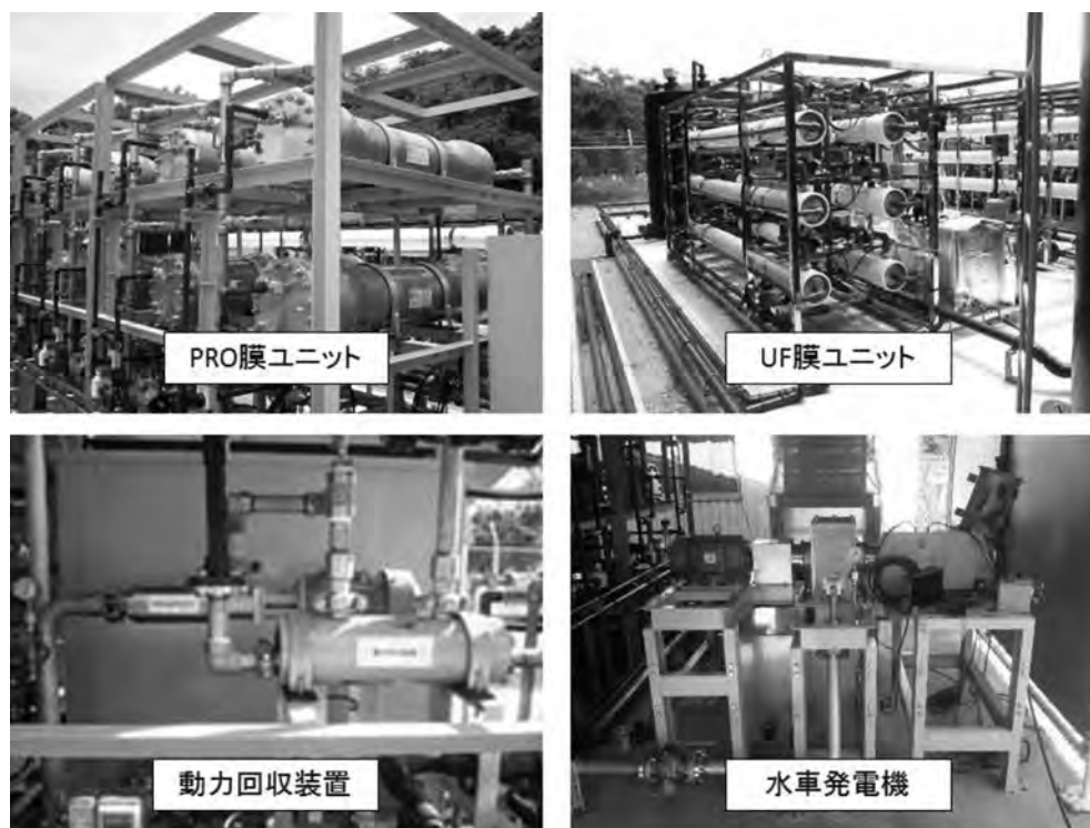
写真—3 PRO システムの構成
