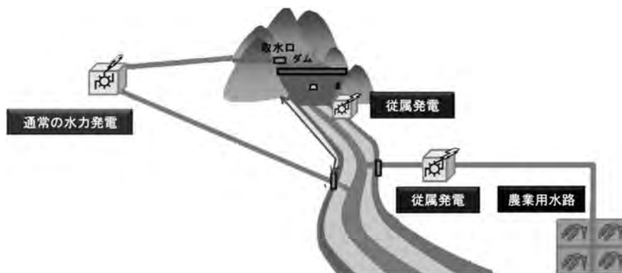
図—1 従属発電と通常の水力発電
