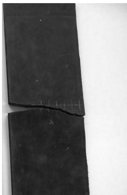
図-13 カット挿入試験片の破断結果
