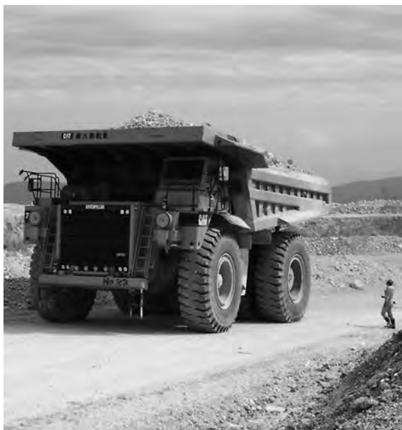
図-2 重ダンプトラック
