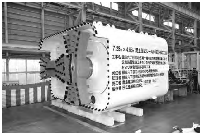
写真1 EX-MAC 工法シールド機
