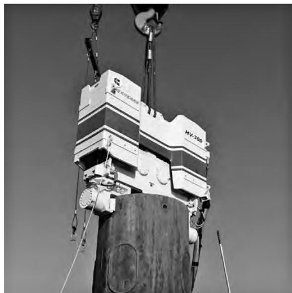
写真1-4 調和工業 HV-300 バイブロハンマ（鋼管チャック）
