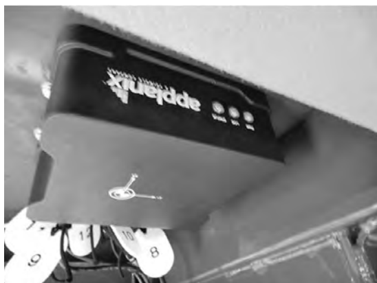
写真一2 GNSS/IMU 装置
