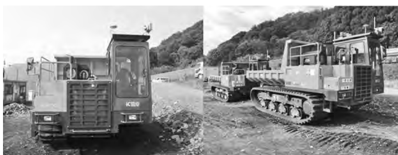
写真ー1 自動走行対応型不整地運搬車
