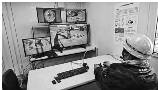
写真ー2 遠隔操縦室
