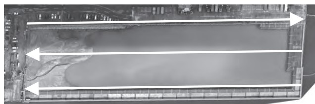
図-7 UAV撮影コース図(オルソ画像)
