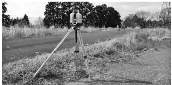
写真-4 地上型レーザースキャナ計測状況
