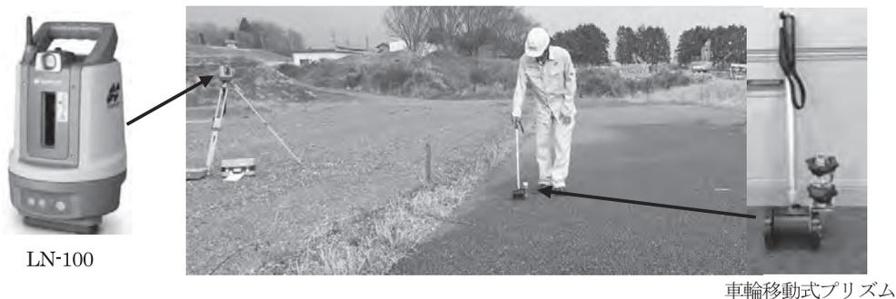
写真-5 車輪移動式プリズムを用いた自動追尾 TS 計測状況
