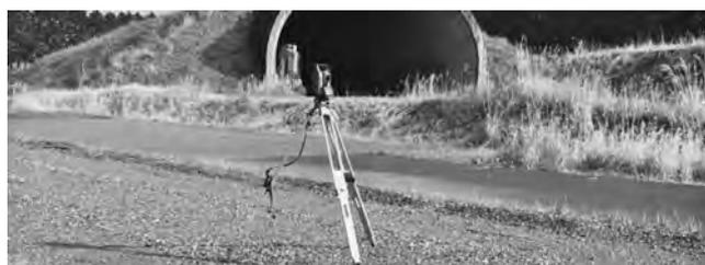
写真-6 ノンプリズム TS 計測状況
