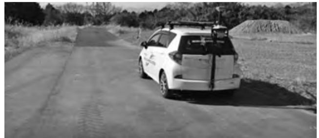
写真-3 移動式路面計測装置計測状況
