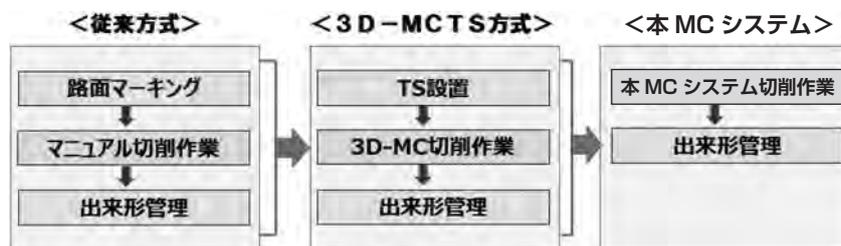
図-7 切削作業フロー図
