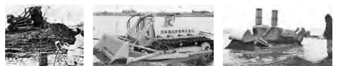
写真—1 初の RC 建機、国土開発と小松の水中ブル
