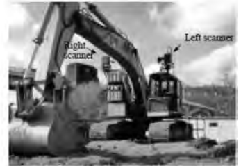
図-11 CMU-TRIの自動掘削・積込機
